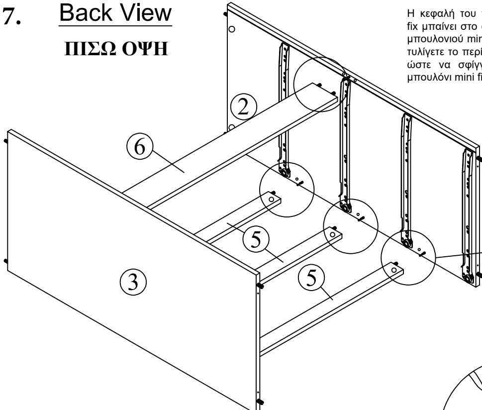
Η κεφαλή του περιβλήματος mini fix μπαίνει στο ανοιχτό στόμιο του μπουλονιού mini fix. Στη συνέχεια, τυλίγετε το περιβλήμα mini fix έτσι ώστε να σφίγγει πάνω από το μπουλόνι mini fix.
