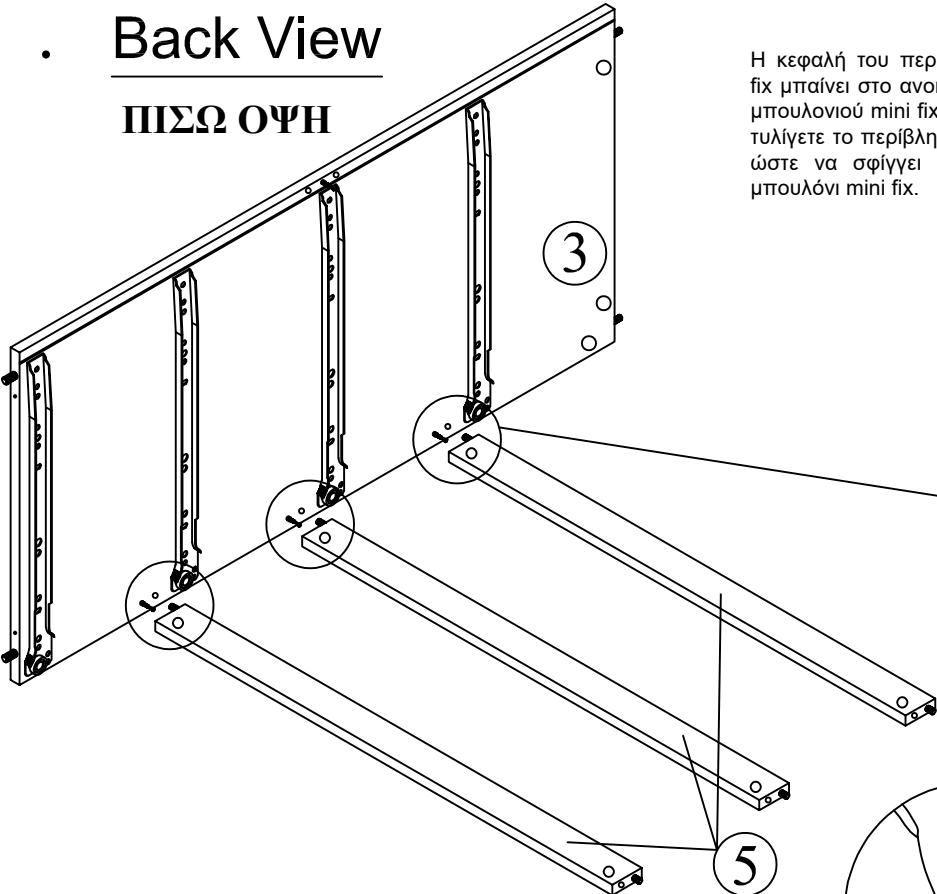
Η κεφαλή του περιβλήματος mini fix μπαίνει στο ανοιχτό στόμιο του μπουλονιού mini fix. Στη συνέχεια, τυλίγετε το περίβλημα mini fix έτσι ώστε να σφίγγει πάνω από το μπουλόνι mini fix.
