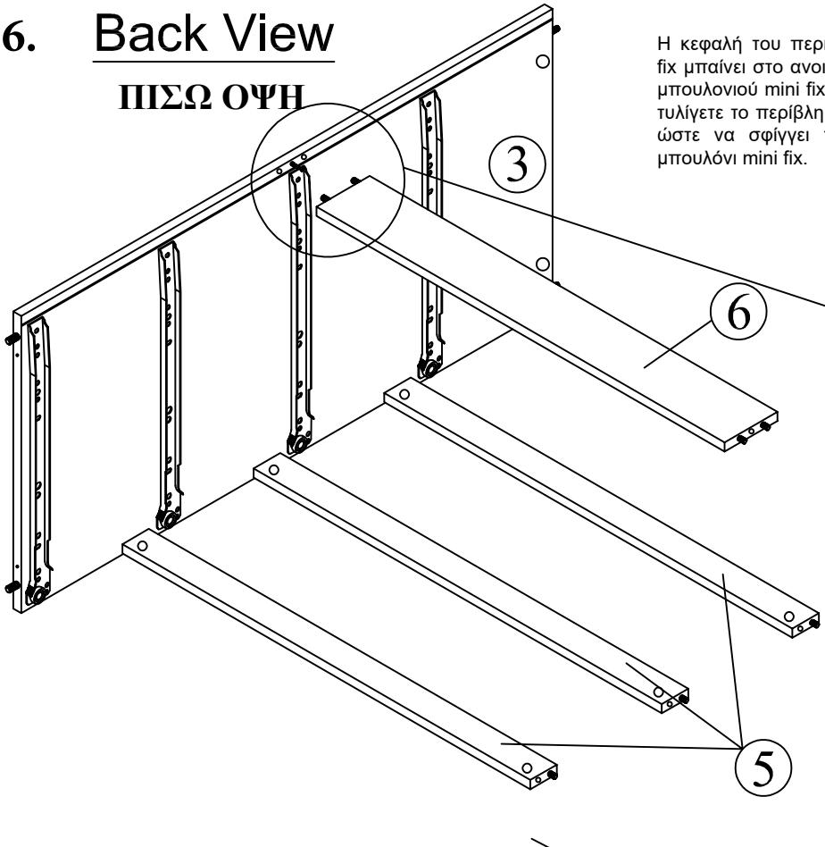
Η κεφαλή του περιβλήματος mini fix μπαίνει στο ανοιχτό στόμιο του μπουλονιού mini fix. Στη συνέχεια, τυλίγετε το περίβλημα mini fix έτσι ώστε να σφίγγει πάνω από το μπουλόνι mini fix.
