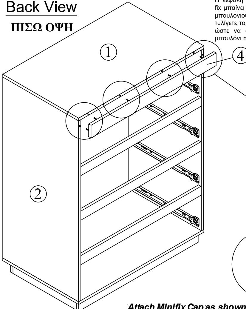
Η κεφαλή του περιβλήματος mini fix μπαίνει στο ανοιχτό στόμιο του μπουλονιού mini fix. Στη συνέχεια, τυλίγετε το περιβλήμα mini fix έτσι ώστε να σφίγγει πάνω από το μπουλόνι mini fix.
