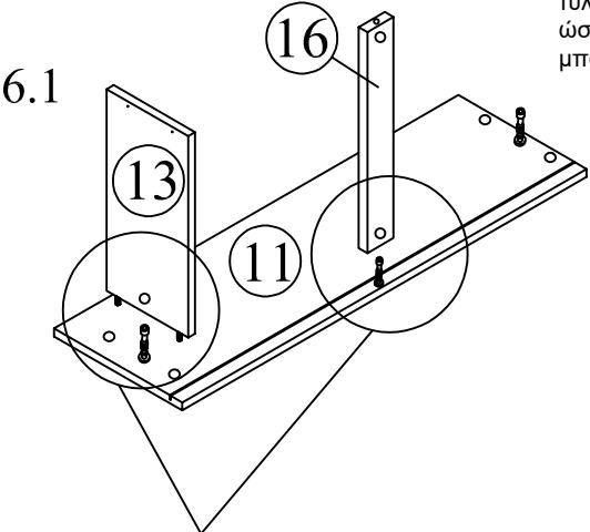
Η κεφαλή του περιβλήματος mini fix μπαίνει στο ανοιχτό στόμιο του μπουλονιού mini fix. Στη συνέχεια, τυλίγετε το περιβλήμα mini fix έτσι ώστε να σφίγγει πάνω από το μπουλόνι mini fix.
