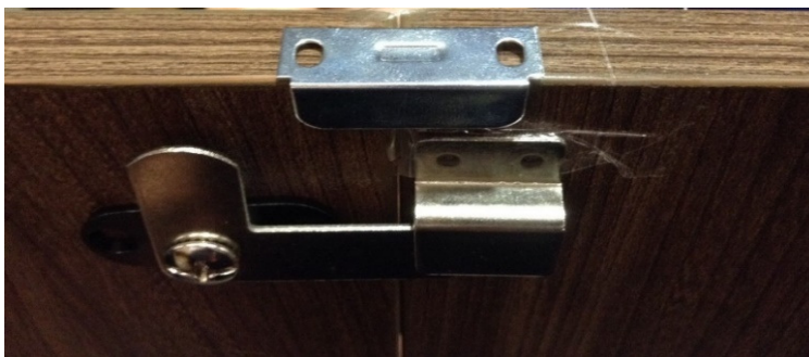
Τοποθέτηση κλειδαριάς βήμα 3/ Placement of lock step 3
